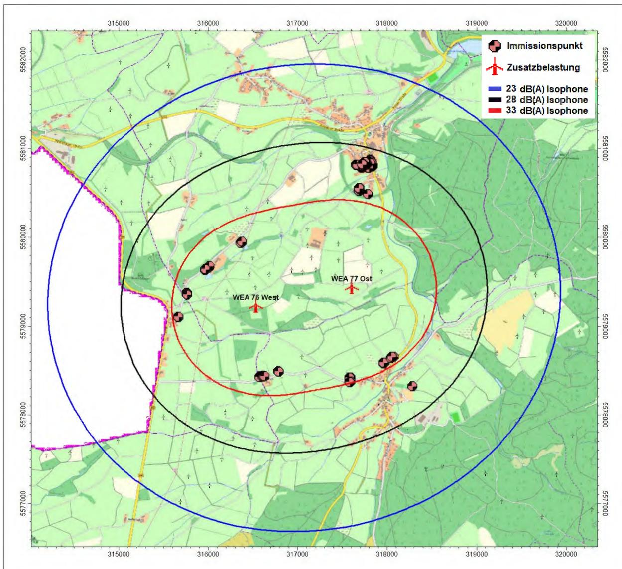
**Abbildung 3: Einwirkungsbereich Zusatzbelastung (Nachtbetrieb - Mode VII, ohne Gelände- und Gebäudeeffekte)  $L_0 = 103,2$  dB(A) (© Geoglis [8])**
