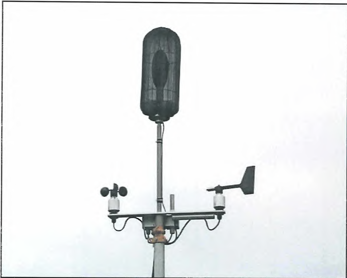
Abbildung 5: Messkopf mit ergänzendem Windschirm
