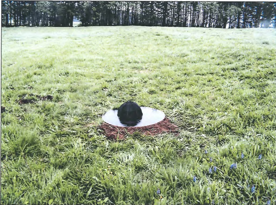
Abbildung 28: Messaufbau Mikrofon mit Windball und sekundären Windschirm auf schallharter Platte.
