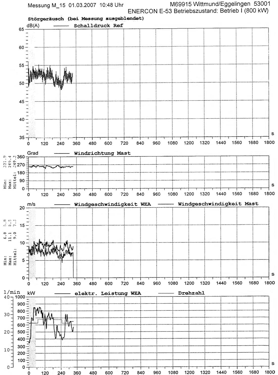
Abbildung A 21. Darstellung aller relevanten Messgrößen der Messung m\_15
