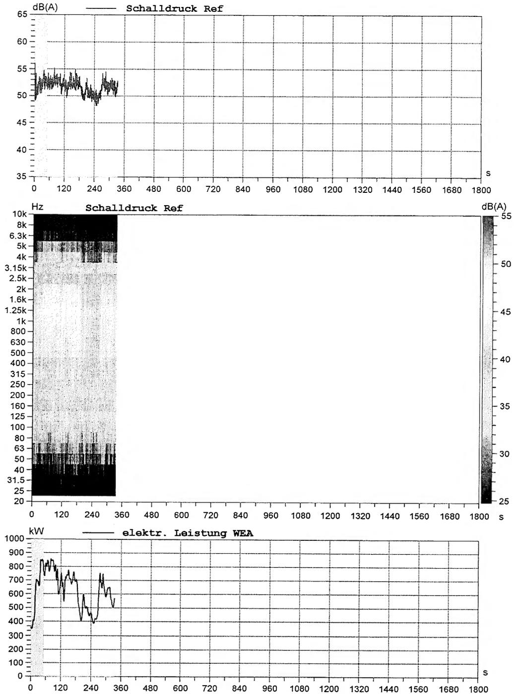
Abbildung A 22. Darstellung Campbell-Diagramm der Messung m\_15
