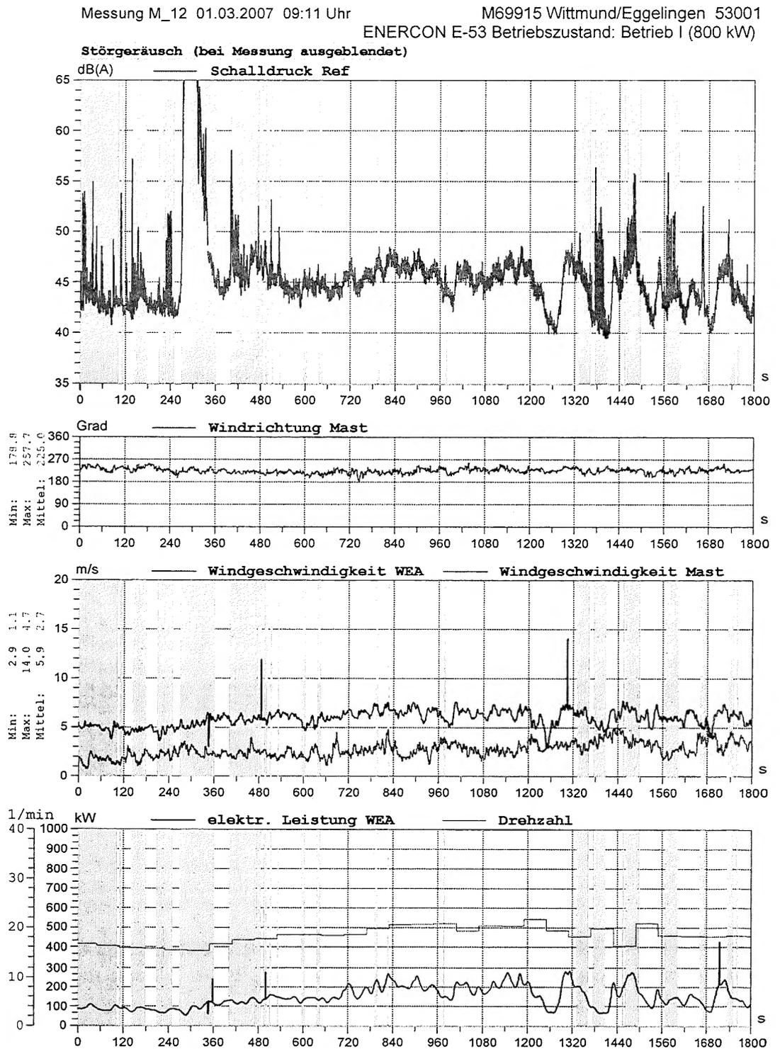
Abbildung A 15. Darstellung aller relevanten Messgrößen der Messung m\_12
