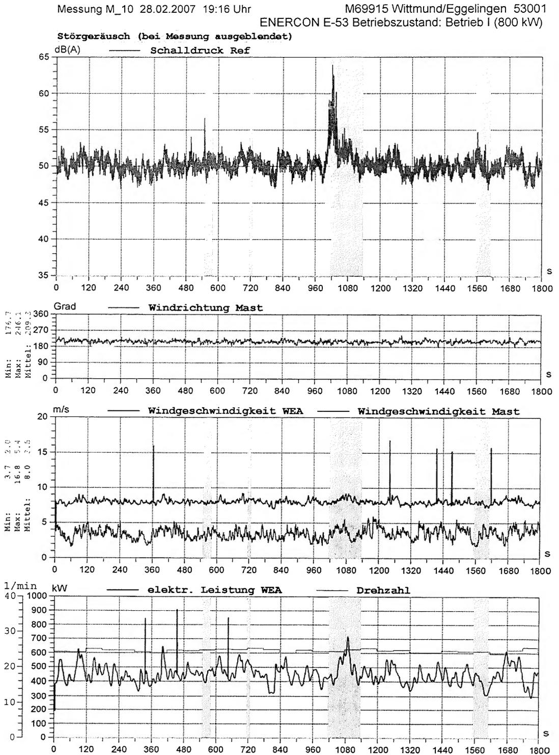
Abbildung A 13. Darstellung aller relevanten Messgrößen der Messung m\_10
