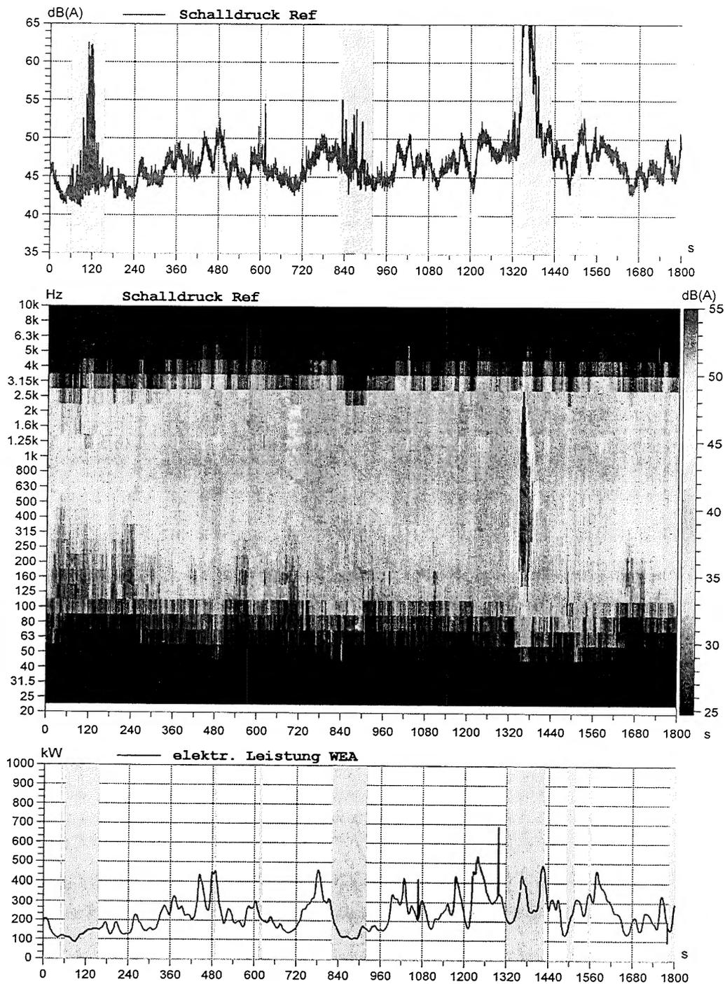
Abbildung A 18. Darstellung Campbell-Diagramm der Messung m\_13
