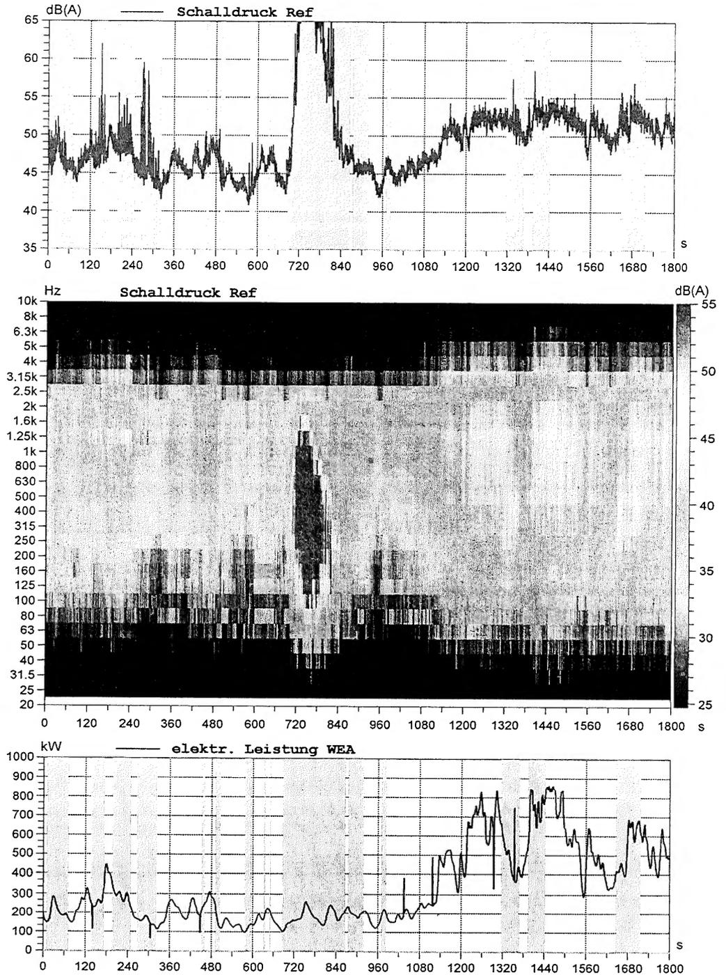
Abbildung A 20. Darstellung Campbell-Diagramm der Messung m\_14
