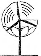
Aerodynamisch bedingte Geräusche verursacht durch die Rotation der Rotorblätter stellen die zweite wesentliche Schallquelle dar. Diese Geräusche sind in der Regel breitbandig und in erster Linie von der Blattspitzengeschwindigkeit und den Blattprofilen abhängig.
