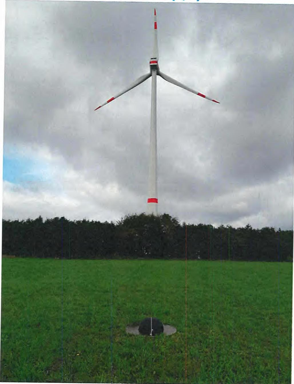
**Foto 2: Foto der schallharten Platte mit Mikrophon unter dem Sekundärwindschirm**
