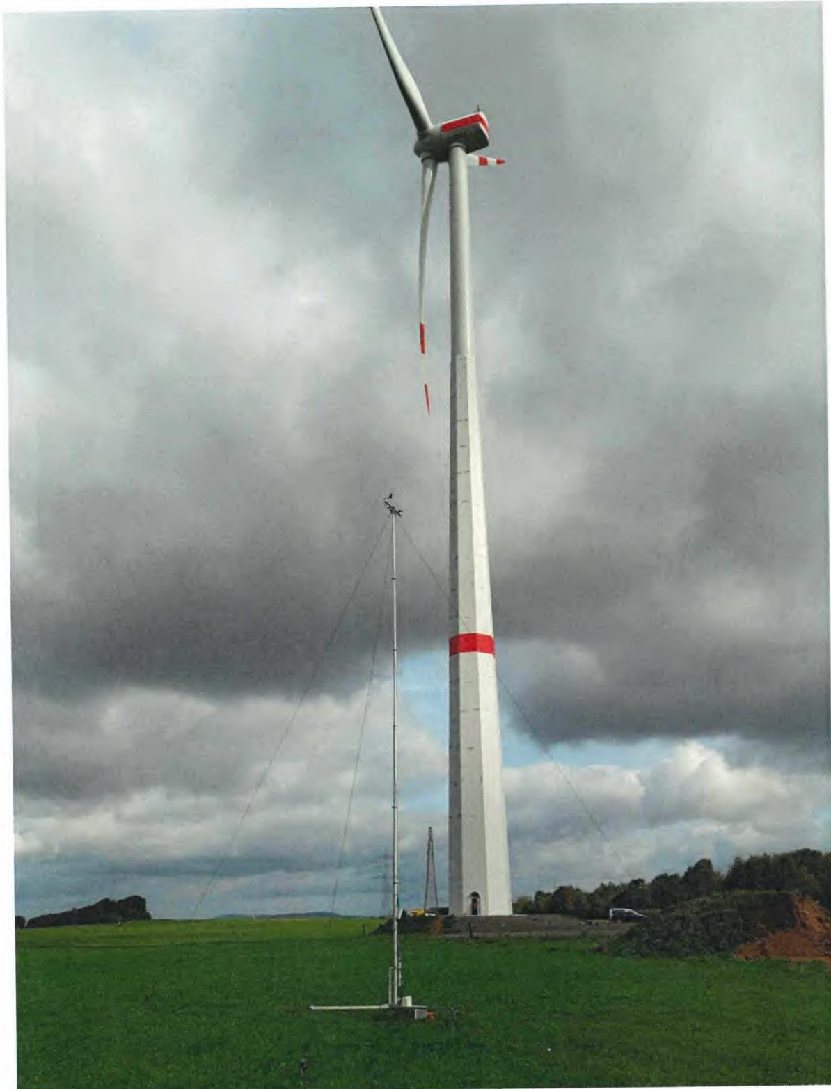
**Bild 8-2: 10 m Windmessmast in Relation zur vermessenen WEA**
