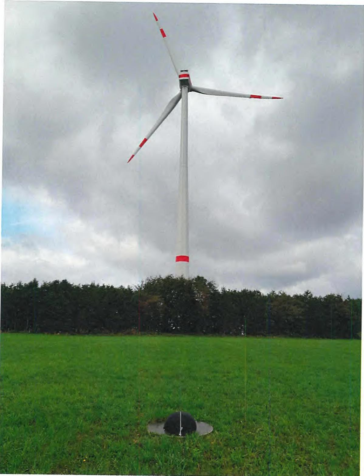
**Bild 8-1: Mikrofonposition in Relation zur vermessenen WEA**
