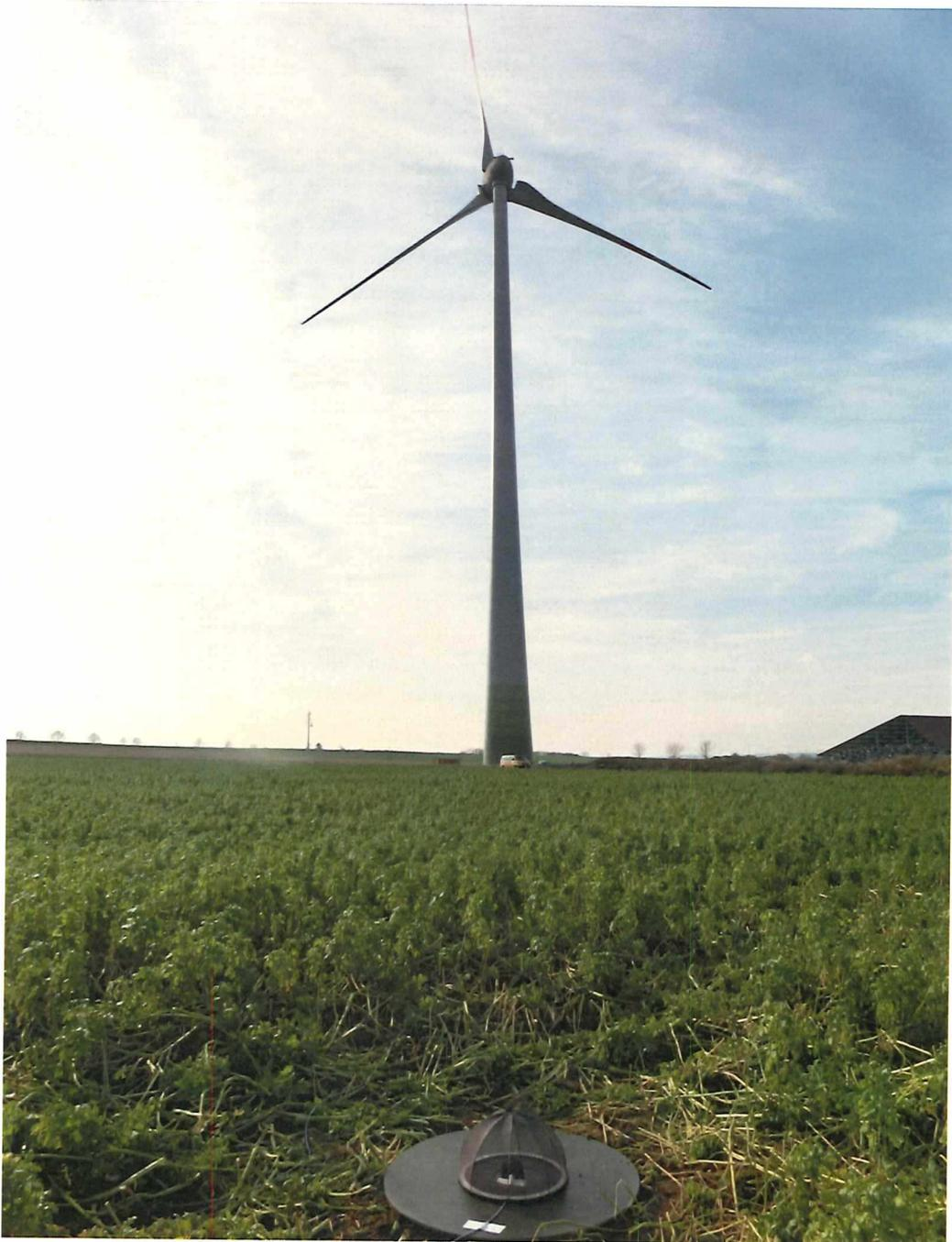
Bild 1:            Mikrofon am Referenzmesspunkt zur E-82 E2 hin (Standort Schöppingen)
