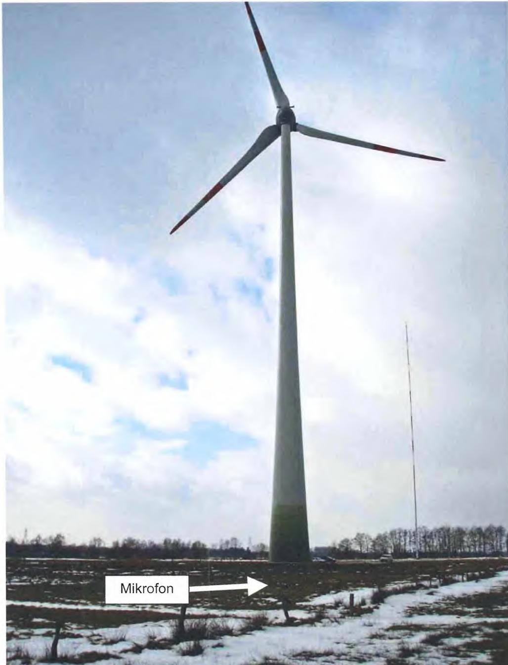
Bild 1: Mikrofon am anfänglichen Referenzmesspunkt zur E-82 E2 hin (Standort Großefehn)
