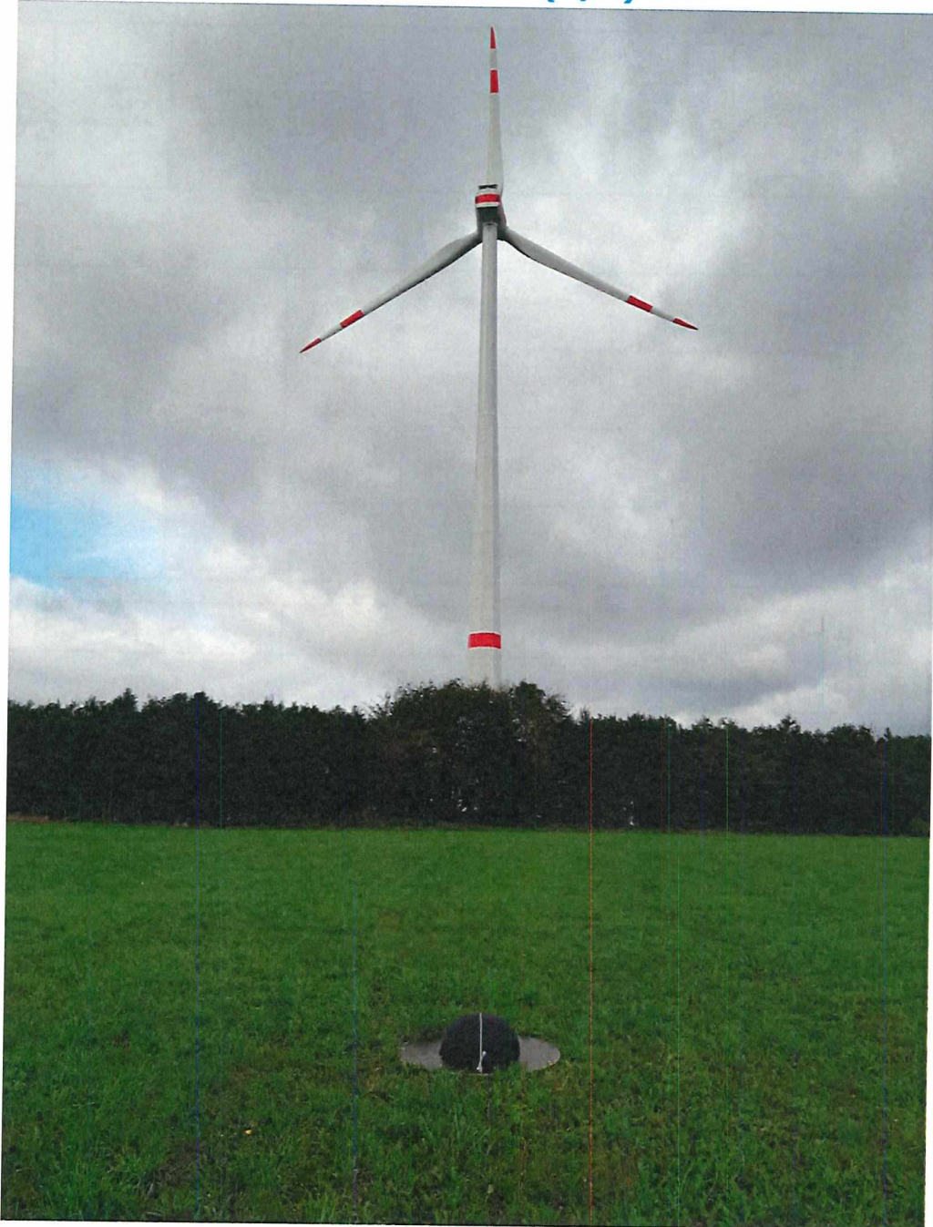
Foto 2: Foto der schallharten Platte mit Mikrofon unter dem Sekundärwindschirm
